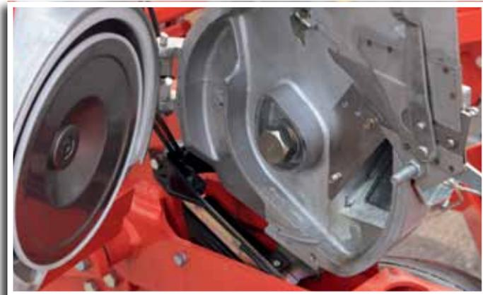
Фотоэлемент на посевном элементе
